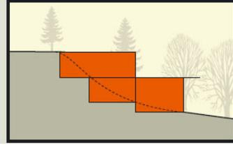
Dans ce cas, la construction se développe perpendiculairement à la pente, et s'ouvre latéralement sur des espaces traversants. L'espace du toit est utilisé pour le stationnement automobile, l'accès est sécurisé pour éviter les chutes, la construction est peu visible dans le paysage.
